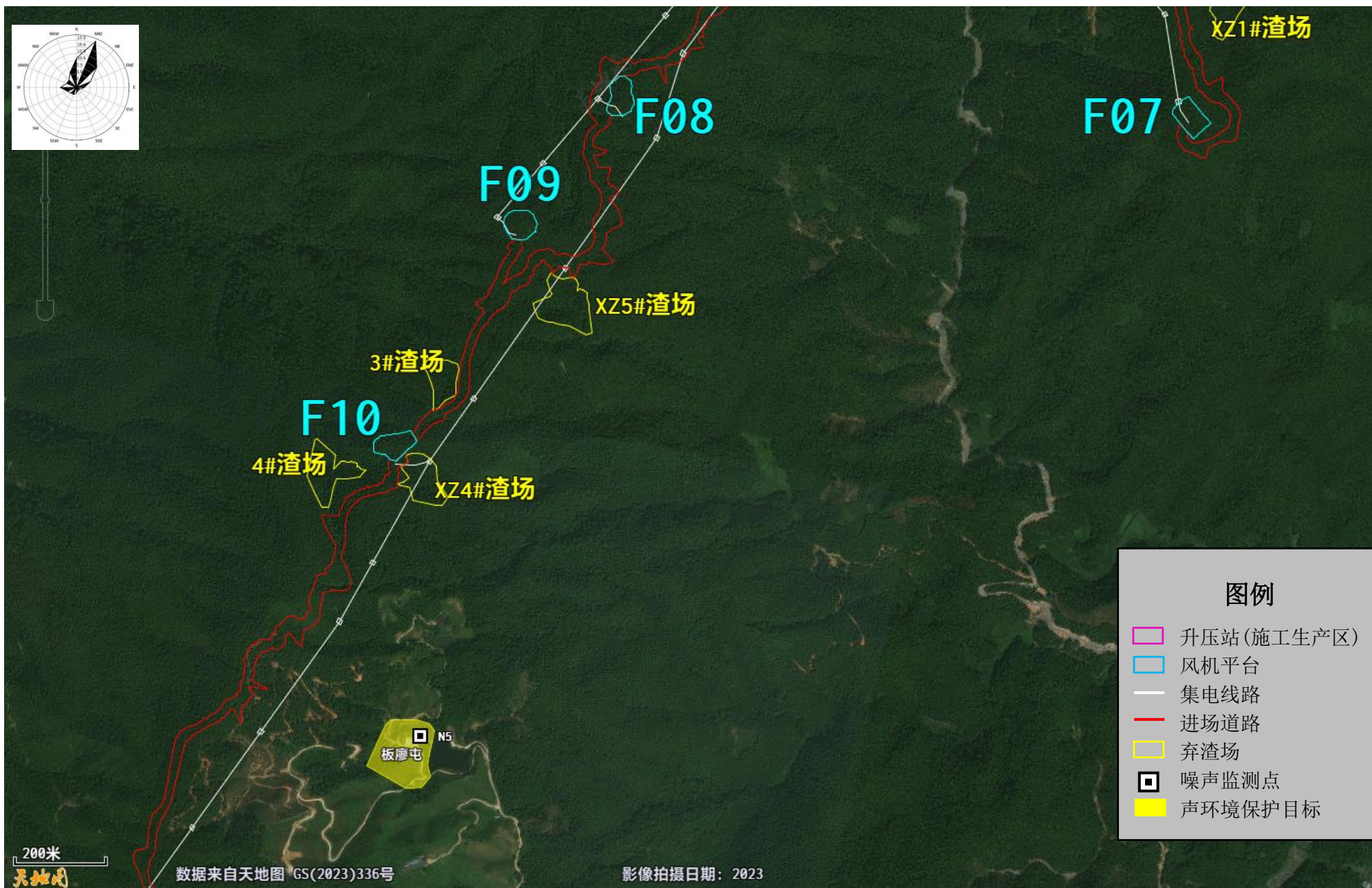
附图 2-2 风电场平面布置、弃渣场、噪声监测点位及声环境保护目标分布图
