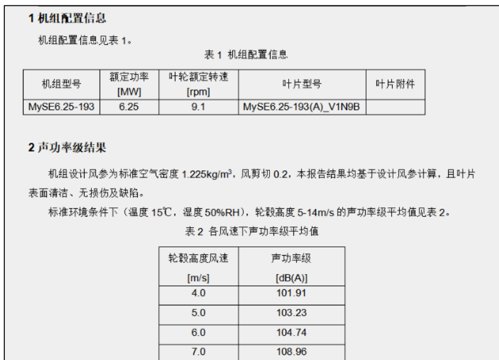
图4.2-2 同类型项目 6.25MW 风机机组噪声分析报告（节选）
