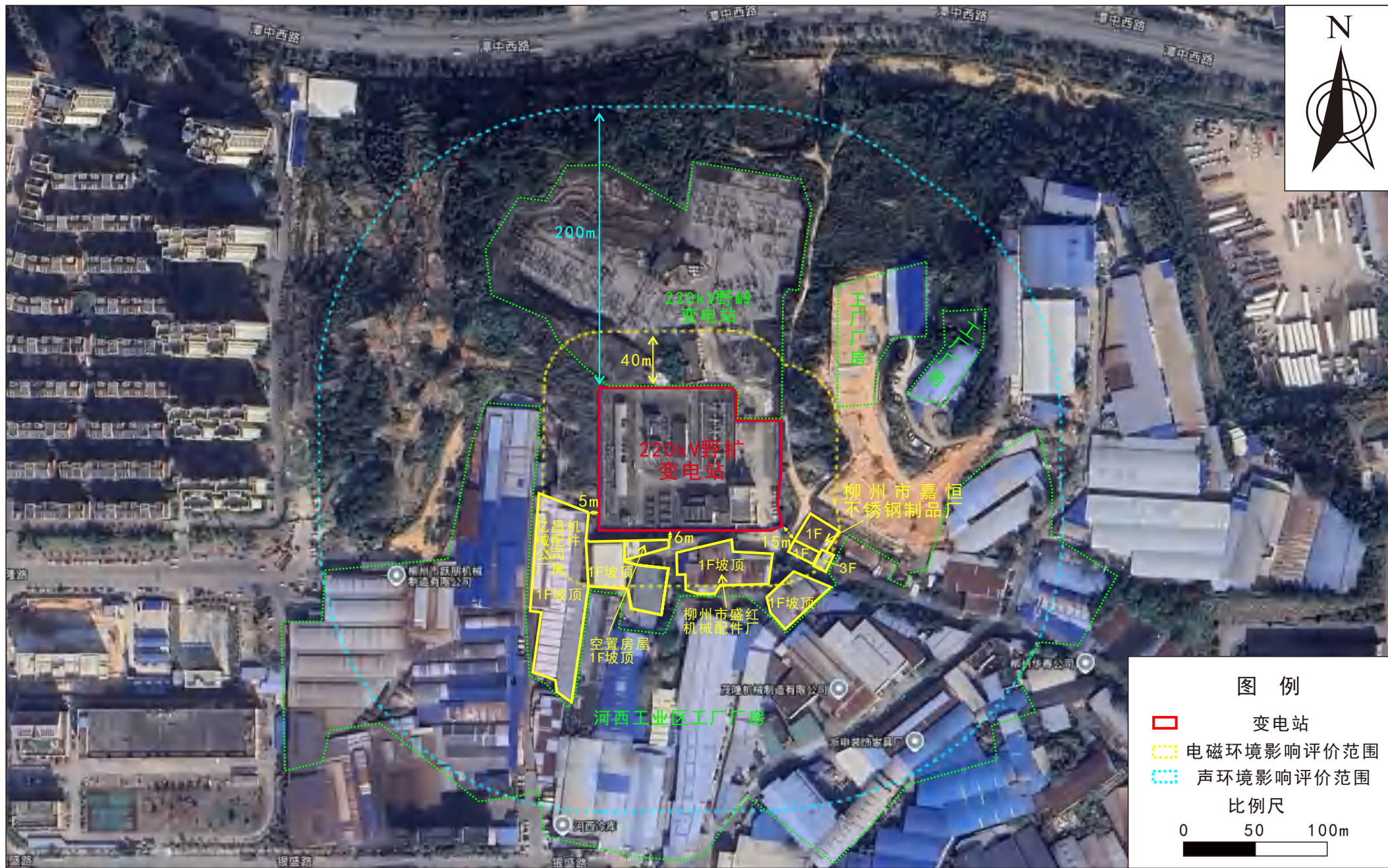
附图3 220kV野扩变电站与周边环境目标相对位置关系示意图
